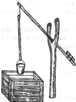
Для подъема воды из колодцев применяют «журавль». Он состоит из толстого бревна с развилкой, к которой крепится более тонкое бревно – балансир. К заднему концу балансира прочно крепят груз в виде отрезка бревна. Балансир крепят так, чтобы его конец (задний) всегда опускался вниз и поднимал тонкий конец с ведром.
